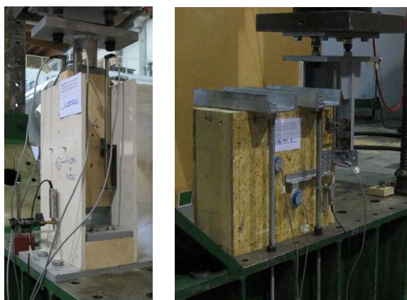
Figura 1. Set-up di prova relativo ai test sui collegamenti pannello-montante e collegamenti parete-fondazione
